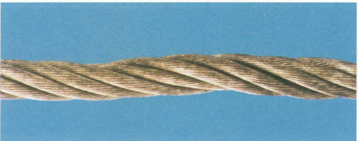
图 D.3 钢丝绳直径局部减小(绳股凹陷)
